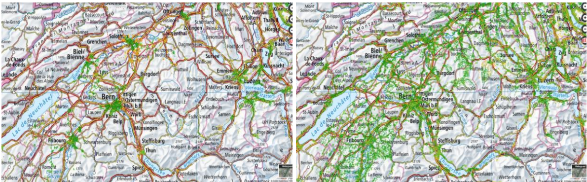
Abbildung 12: Abdeckung Glasfaser-Netzwerkinfrastruktur (links) im Vergleich zur Abdeckung Koaxialkabel-Netzwerkinfrastruktur (rechts) (regionaler Ausschnitt)
